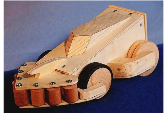
Der Bau beginnt mit dem Aussägen des Bodens und der bugförmigen Bumperdecke, die als Halterung für die 7 Rollen bestimmt ist. Der Bauplan Abb.2 zeigt den Boden in Originalgröße. Das Material sollte 4mm Pappelspertholz sein. Die Zeichnung kann als Schablone dienen und muss an der gestrichelten Linie umgeklappt (gespiegelt) werden. Am Boden müssen folgende Schraubenlöcher gebohrt werden: Motorhalterung 3mm, Seitenwandbefestigung 2mm, Bumperrollen 3mm. Für den Motor wird eine kleine
