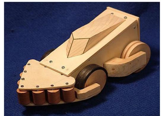
Die Decke wird mit 4 Schrauben befestigt (2,2x16) und erhält eine besondere Gestaltung als „Cockpit“. Das kann wie hier ganz schlicht mit einer Holzleiste geschehen, die mit Säge und einer Raspel in Form gebracht wird. Fantasievollere Variationen sind durchaus möglich. Da das keilförmige Holz beim Leimen nicht so leicht mit einer Zwin-gel zu halten ist, können hier zwei kleine Schrauben von unten das Cockpit auf die Deckenplatte etwas anziehen.
